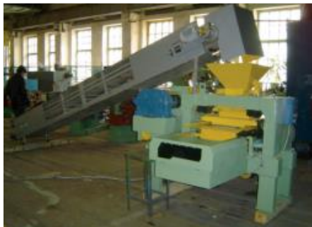
Рис. 1. а) Установка РК-250 предназначенная для производства перегородочных изделий методом полусухого прессования, б) готовое изделие из фосфогипса
