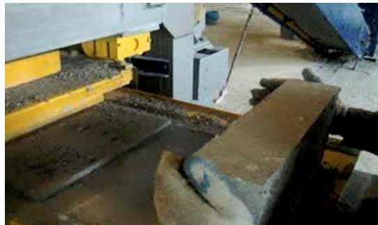
Рис. 1. а) Установка РК-250 предназначенная для производства перегородочных изделий методом полусухого прессования, б) готовое изделие из фосфогипса
